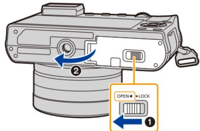
**2** 배터리 : 배터리 방향에 주의하면서 잠기는 소리가 들릴 때까지 계속 넣은 후 레버 ①로 잠겼는지 확인하십시오.
